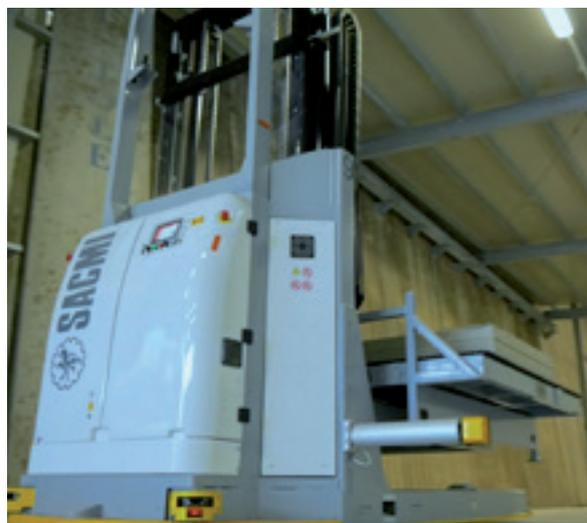
zioni in cotto, completamente in automatico». Merito di 14 navette laser guidate che permettono la movimentazione in automatico, ottimizzando la logistica e le tempistiche di processo, e di un'automazione particolarmente 'spinta' che garantisce all'impianto una versatilità unica, «grazie alla poca manutenzione richiesta dal sistema e alla sua capacità di attuare il cambio formato con la massima rapidità».
