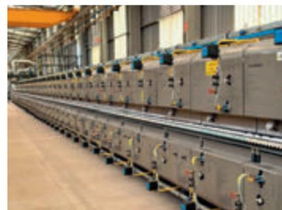
bustione stechiometrico mantenuto costante al variare della potenza richiesta). La facilità di manutenzione e ispezione e la migliore miscelazione a vortice sono ulteriori caratteristiche che qualificano il bruciatore IWB come componente standard dei forni ICF & Welko, utilizzabile anche con miscele di idrogeno e metano quali combustibili.
