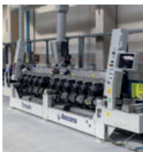
mento dello stato macchina-produzione e guidando l'operatore passo dopo passo. TORNADO è la nuova squadratrice a secco per grandi produzioni ceramiche, costruita con materiali di altissima qualità e completamente automatica: può essere collocata all'uscita dal forno, consentendo l'efficientamento del processo di squadratura e abbattendo di conseguenza notevoli costi logistici e di gestione anche grazie alla totale massimizzazione della produttività, capace di raggiungere fino a 20mila m2/giorno.
