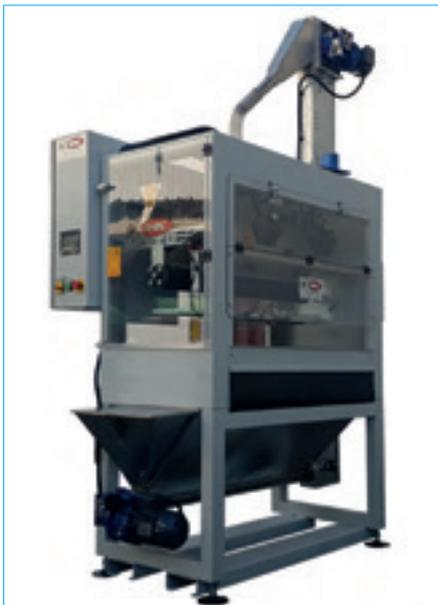
Composta da una struttura autoportante completamente chiusa per evitare dispersioni in ambiente, la macchina si avvale di un rullo motorizzato rivestito in gomma per gestire l'estrazione e il dosaggio del materiale da applicare, di una vasca di raccolta in acciaio inox con sistema antintrusione, di un gruppo di alimentazione, trasporto e riciclo polveri e di tramoggia per dosatura con sistema di distribuzione autolivellante.
