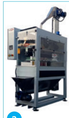
2 La gestione della macchina è completamente automatica, tramite quadro elettrico di controllo con PLC e tastiera di programmazione.
