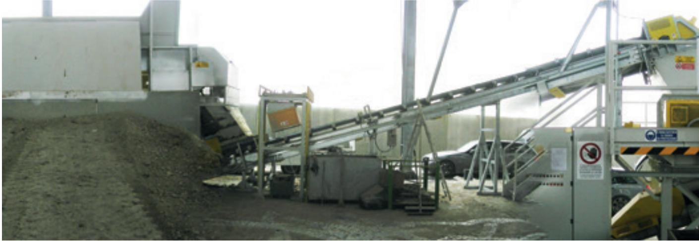
L'impianto di frangizollatura posizionato presso "Sibelco Italia", stabilimento di Ravenna, con installazione di n°2 linee di frangizollatura, comprendente n°2 sminuzzatori Sm-500 e relativi cassoni alimentatori a tapparella, con potenzialità di 180 Ton/H cad.
