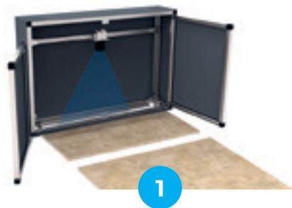
Installato in linea subito dopo la stampante inkjet, è dotato di telecamera lineare con una risoluzione ad altissima precisione (4K) che permette una rapida scansione della superficie della lastra.
